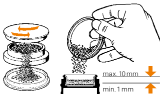
Llenar el Depósito
