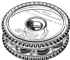
Colocación de la tapa del Depósito
