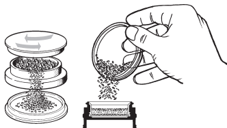
Llenar la Cámara de Relleno hasta un máximo debajo del borde de la tolva
