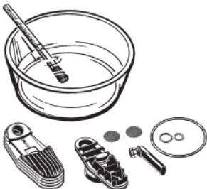
► Sumerja todas las piezas de la Unidad de Enfriamiento (excepto el cierre de la Tapa), así como la Malla de la Cámara como máximo 1/2 hora en alcohol isopropílico.
