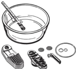
► Immergere tutti i componenti di plastica dell'Unità di Raffreddamento (eccetto il Chiavistello del Coperchio) e il Filtro della Camera di Riempimento nell'alcol isopropilico per 1/2 ora al massimo.
