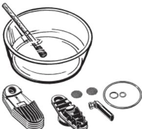
► Laisser toutes les pièces de l'Unité de Refroidissement (sauf le Verrou de Couvercle) ainsi que le Tamis de la Chambre de Remplissage pendant une demi-heure au maximum dans l'alcool isopropylique.
